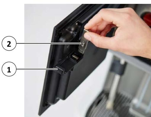
Fig. 40 : Insertion d'une clé USB
